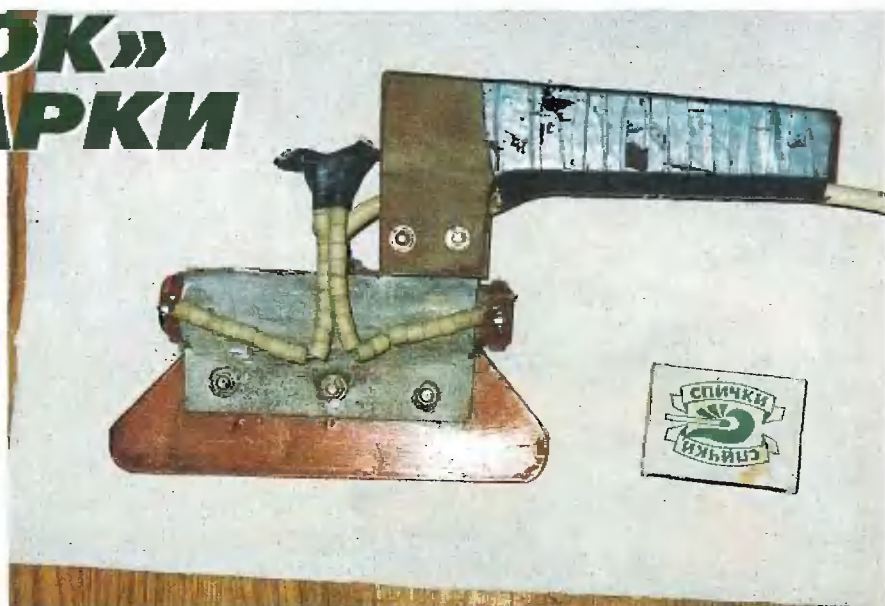
Рис. 1. Конструкция «утюжка»: 1 — постоянный проволочный резистор; 2 — металлический корпус; 3 — жало-конек; 4 — текстолитовая ручка; 5 — подставка.
